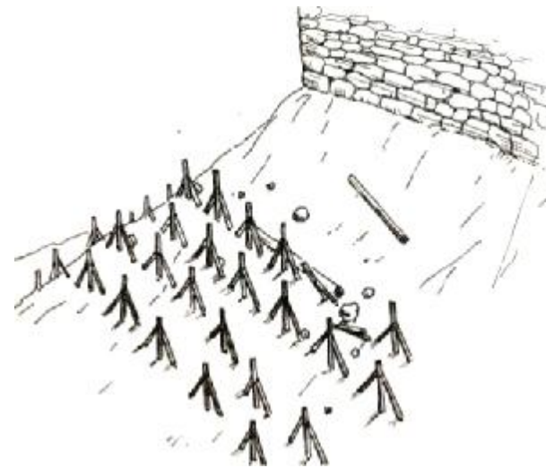
Рис. 164. Защита от скатываемых предметов с помощью трезубцев
