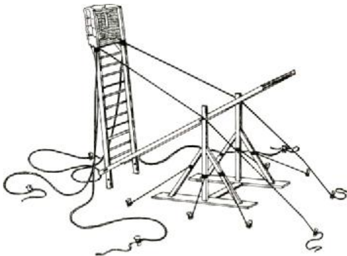
Рис. 158. Наблюдательная вышка в опущенном положении
