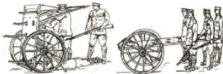
Рис. 40. Мантлет XX в. Британская модель (в положениях для боя и транспортировки)
