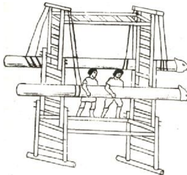
Рис. 58. Таран для разрушения парапета стены. Конструкция с параллельными лестницами и двумя таранными балками. По книге Анонима Византийского «Инструкции по полиоркетике»
