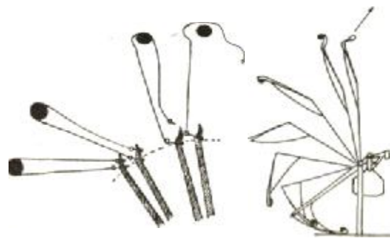
Рис. 128. Спуск пращи, два варианта
