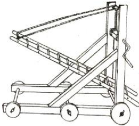
Рис. 35. Лестница на колесной платформе, по Валтурио, 1472 г.
