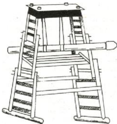
Рис. 57. Таран для разрушения парапета стены. Конструкция с наклонными лестницами и одной таранной балкой. По книге Анонима Византийского «Инструкции по полиоркетике»
